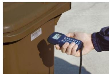
Ogni operatore ecologico è dotato di un palmare completo di lettore ottico e di tasti per la selezione del livello di riempimento di ogni singolo contenitore svuotato.
